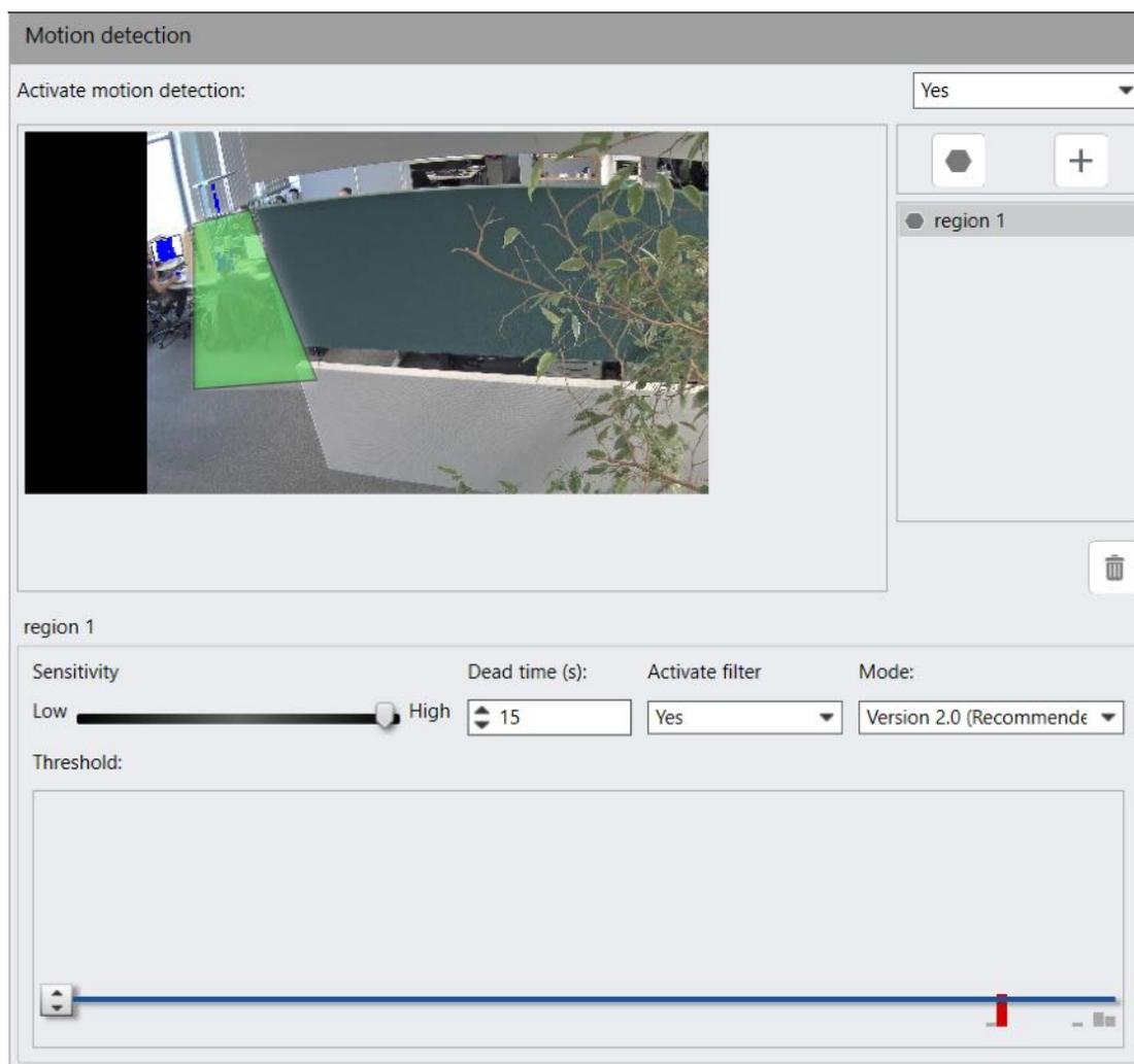
**Fig. 134: Motion detection**
